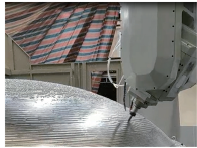
(a) 整体箱底镜像铣削过程
